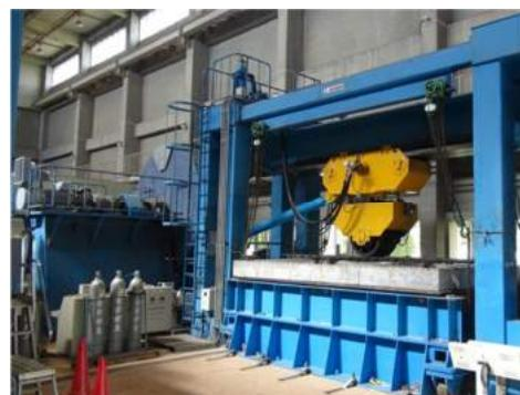
写真-2 輪荷重走行試験状況
