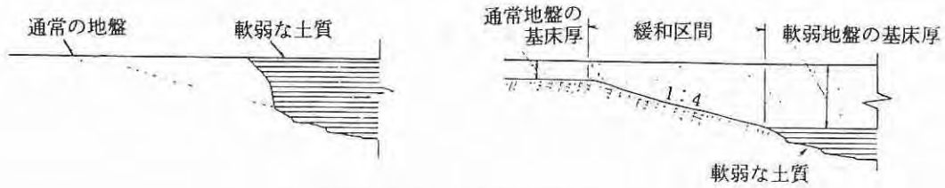
地盤が変化する場合の基床の例
